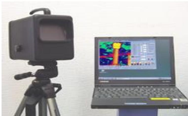
Рис. 2.7 – Матричний тепловізор марки ТК-1
